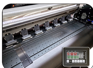
Rampe chauffante pour la fixation des encres en surface
