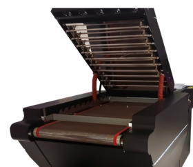
Séchage uniforme garanti grâce aux 10 tubes chauffants
