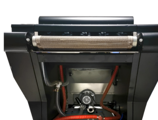
Tapis aspirant pour réduire la perte de papier lors du début et de la fin de l'impression
