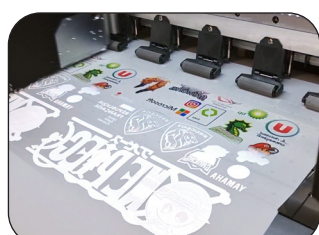
Entrainement du film par galets à friction
